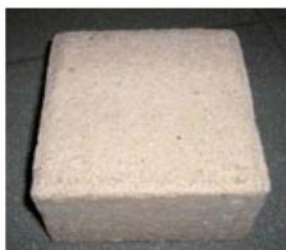
Pavés en béton poreux
